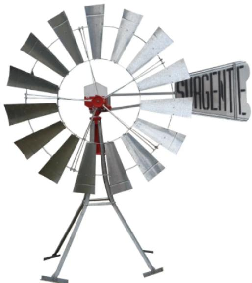
MÁQUINA, RUEDA Y COLA Incluye bases para instalar en torres de cualquier otra marca. Incluye además base guía columna, base apoya crapodina, crapodina completa. Funciona con vientos leves, a partir de los 5 km Aprovechan un 60% más los vientos Caudal de agua continuo con vientos leves. Bomba de aceite automática, mientras funciona el molino, lubrica el sistema de trabajo. Freno automático contra vientos mayores a 55 km.
