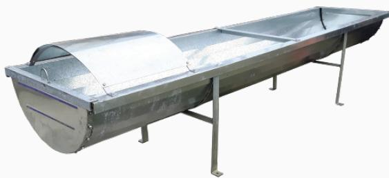
Tanque de media caña para almacenamiento de agua. Con patas y larguero. Capacidad: 470 litros Material: chapa galvanizada N°18 Color: metal Dimensiones: Largo: 3 metros. Ancho: 0,73 metros. Altura Total: 0,65 metros.
