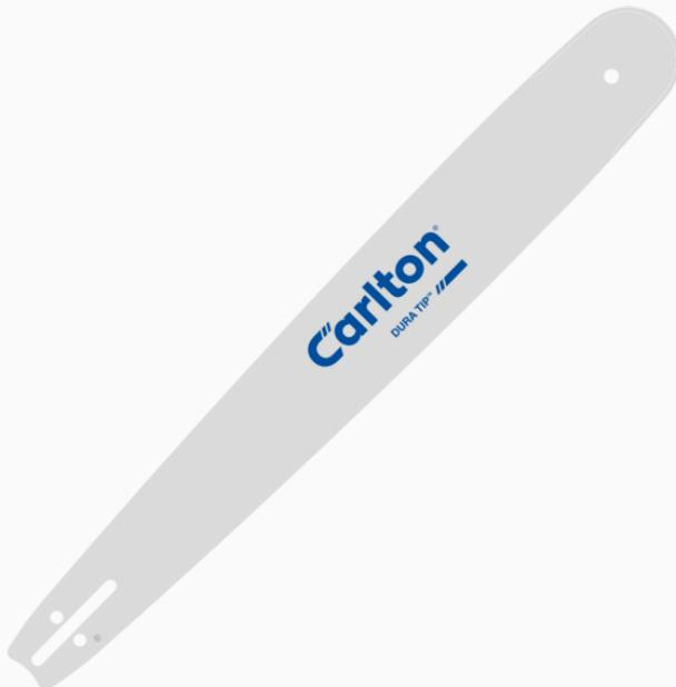
Espada de la línea DURATIP de Carlton, diseñada para brindar máxima seguridad y durabilidad en motosierras de uso profesional. Con 45 cm de largo, paso de cadena compatible y calibre de 1,3 mm, ofrece un corte preciso y resistente. Su punta reforzada prolonga la vida útil y asegura un desempeño confiable en trabajos intensivos de tala y poda.
