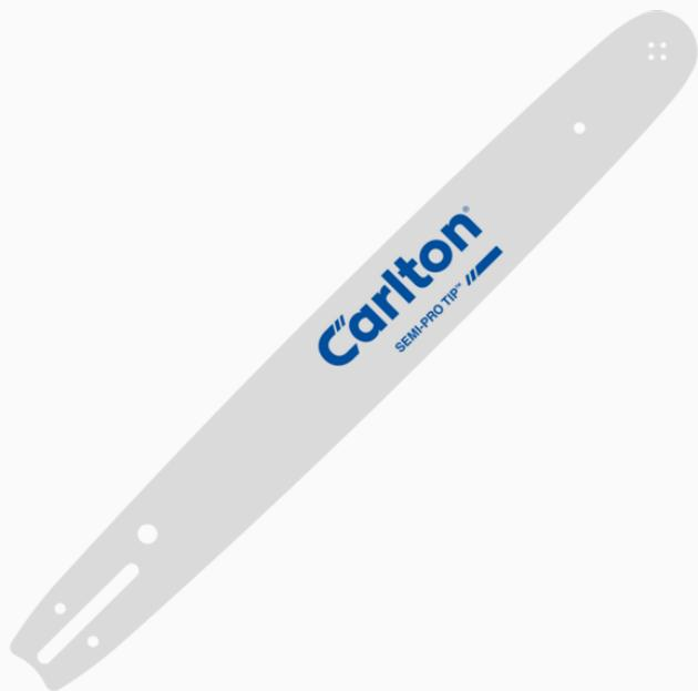
Espada Carlton SEMIPRO.: Rendimiento confiable para trabajos exigentes. La espada Carlton SEMIPRO de 35 cm combina precisión y durabilidad en un diseño robusto. Con paso 3/8" bajo perfil y un calibre de 1.3 mm, es ideal para motosierras universales. Su punta Semi-Pro reduce el retroceso y mejora el control, brindando seguridad y eficiencia en cada corte.
