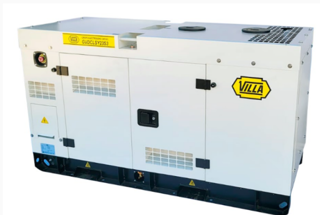
Panel digital, Motor Villa MVL4-33Y (4 cilindros en línea, 1500 rpm) potencia 23 KVA. Trifásico / 50 Hz 200 -380V
