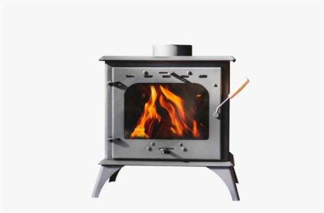
Con pulmón para doble combustión, bajo consumo y alto rendimiento. Espesor de la chapa 4mm. Con doble chapa posterior, calor por irradiación y convección. Doble regulador de entrada de oxígeno para rápido encendido.
