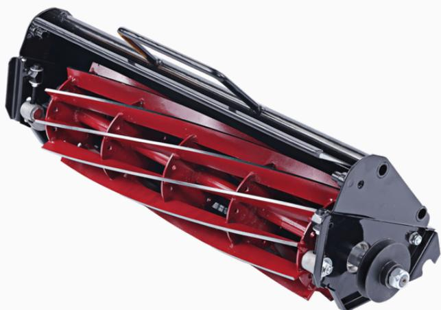
Para obtener un acabado más fino, se puede instalar un cartucho opcional de 10 cuchillas en lugar de la unidad estándar de 6 cuchillas. Esto permite cortar a alturas más bajas y lograr céspedes más finos que con la unidad estándar. El rango de altura de corte es de 12 a 32 mm, y la profundidad de trabajo varía entre 3 y 30 mm.
