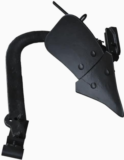
Arado diseñado para la preparación del suelo antes o después de la cosecha. Despeja la tierra hacia un lado de manera eficiente, facilitando las operaciones en el campo. Profundidad de trabajo: 250 mm.
