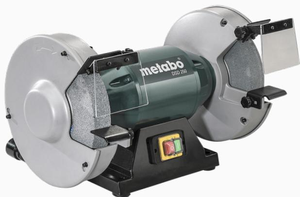
Esmeril doble Trifásico, de gran potencia (900 W) con motor de inducción sin vibraciones y silencioso (1490 rpm). Diámetro de piedra esmeril 250x40x51 mm. Con seguro contra arranque involuntario. Cubierta con cierre de bayoneta para un rápido cambio de piedras esmeriles. Cristales protectores contra chispas de gran dimensión. Conexión para aspiración en ambos lados Ø 35 mm.
