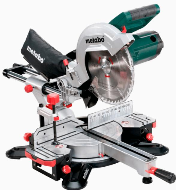
Ingletadora (con función de tracción) 1800 W. Hoja de sierra Ø 254 x 30 mm. Capacidad de corte 90°/90°: 305 x 92 mm. Capacidad de corte 45°/45°: 205 x 47 mm. Aspiración de viruta. Laser para indicar línea de corte. Luz LED de trabajo. Pinza para fijación de pieza.
