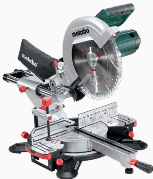
Ingletadora (con función de tracción) 2000W. Hoja de sierra Ø 305 x 30 mm. Capacidad de corte 90°/90°: 305 x 105 mm. Capacidad de corte 45°/45°: 205 x 67 mm. Aspiración de viruta. Laser para indicar línea de corte. Luz LED de trabajo. Pinza para fijación de pieza.
