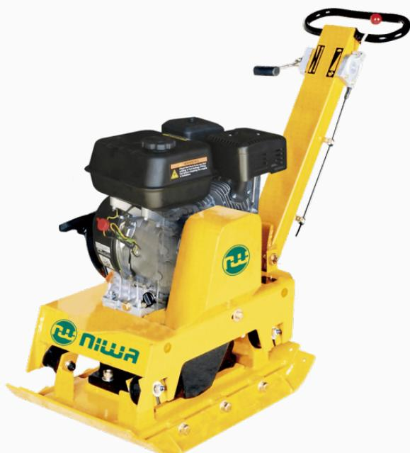
La plancha reversible puede avanzar y retroceder gracias al doble excéntrico. Con 160 kg de peso y 6,5 HP de potencia, se usa para compactar hasta 0,50 m de espesor de suelo
